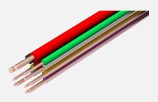
STRIP BACK RED AND BLACK CORES **2MM** AND ALL REMAINING CORES **5MM**, THEN TIN ALL CORES
