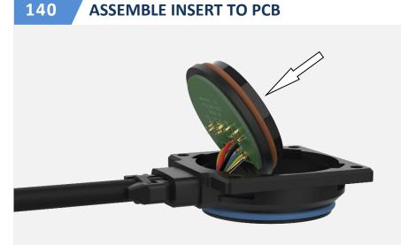
FIT SEAL OVER SPRING CONTACTS, PUSH THE SEAL ALL THE WAY DOWN TO THE PCB, MAKING SURE IT IS ENTIRELY FLAT.
