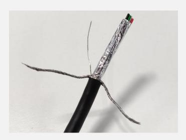
PART AND TWIST THE BRAID BACK INTO TWO EVEN STRIPS
